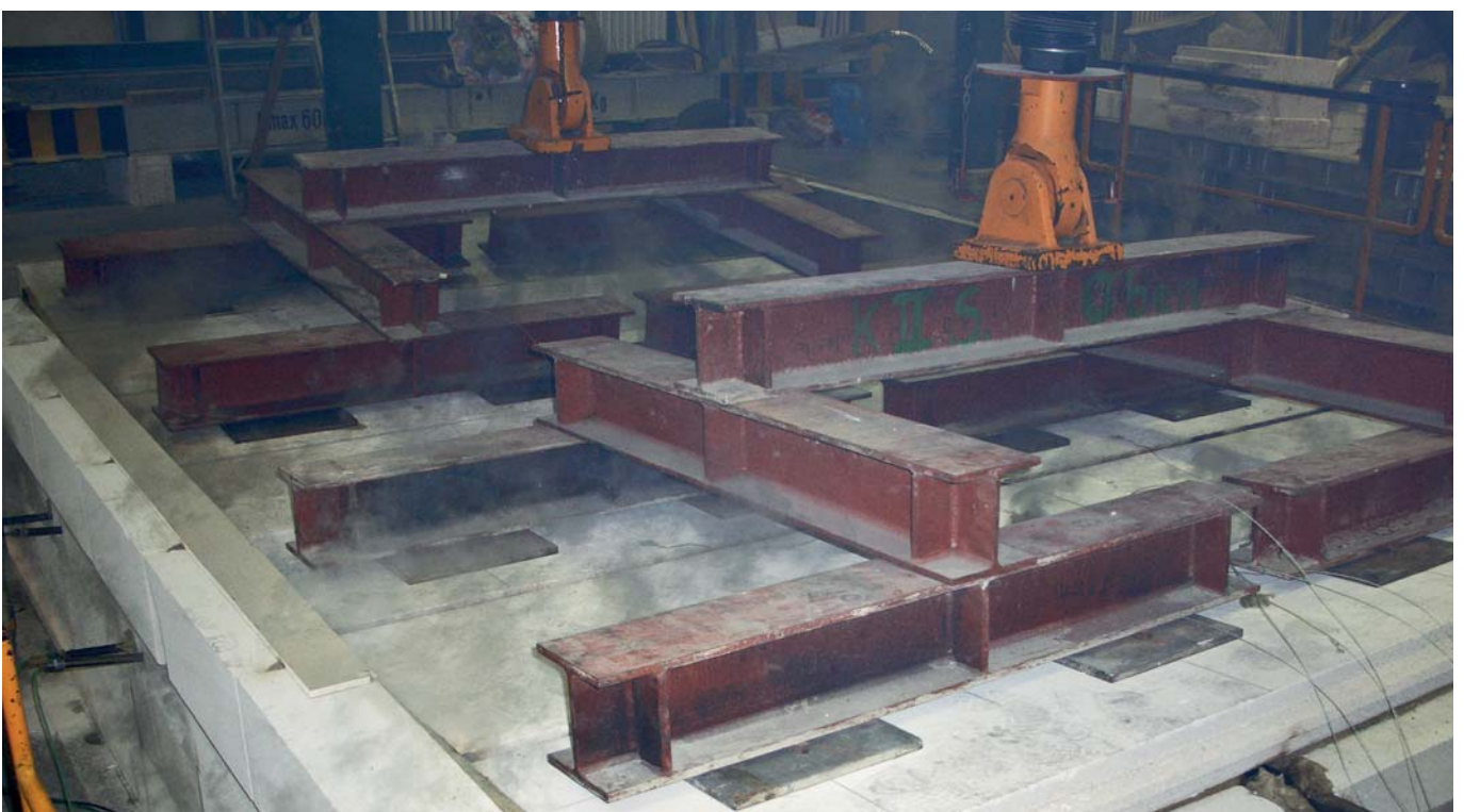
Prüfungsabau einer Decke unter Rohdecken der Bauart I nach erfolgreicher Brandschutzprüfung F 30 (Belastungstest)
