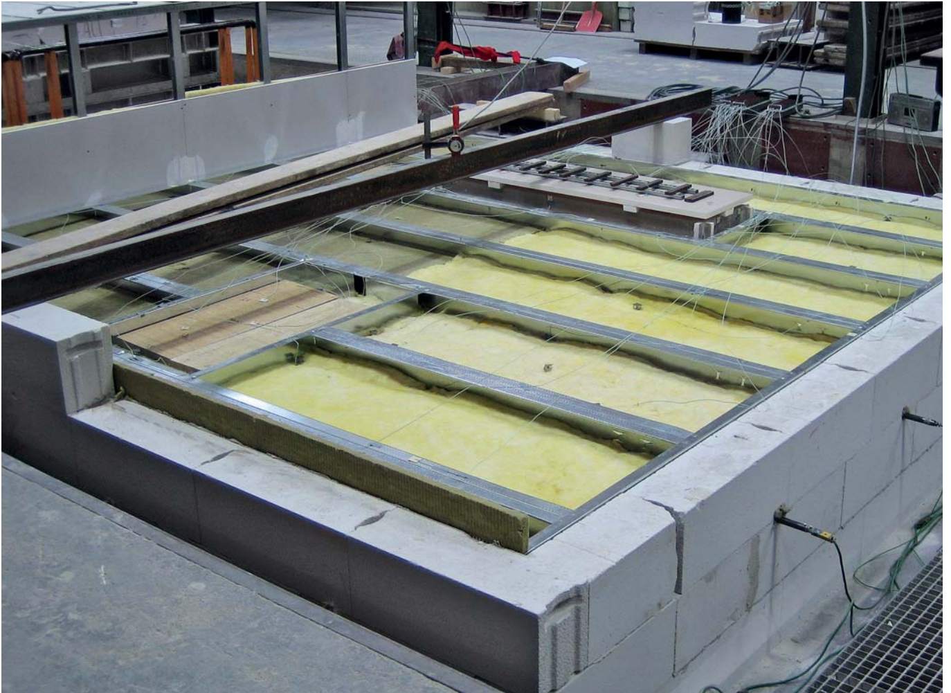
Prüfungsabau einer freitragenden F 30 Decke
