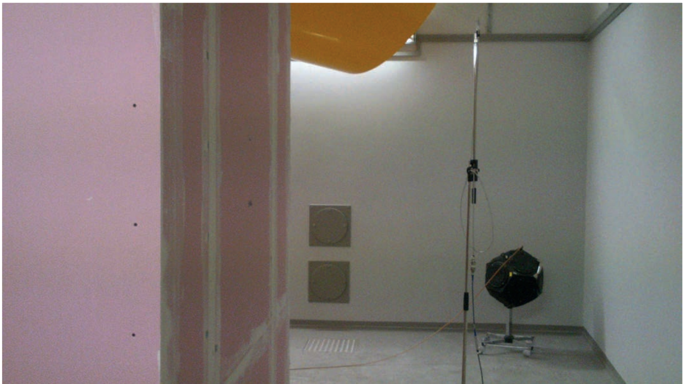
Siniat Raumsystem während der Schallprüfungen im Hallraum
